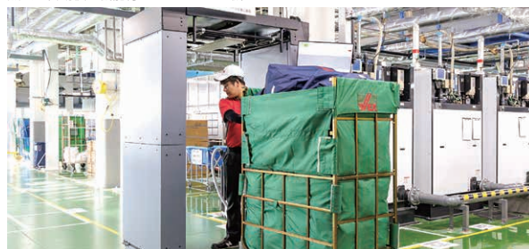
客室リネンに取り付けられたRFIDチップの読取りゲート
